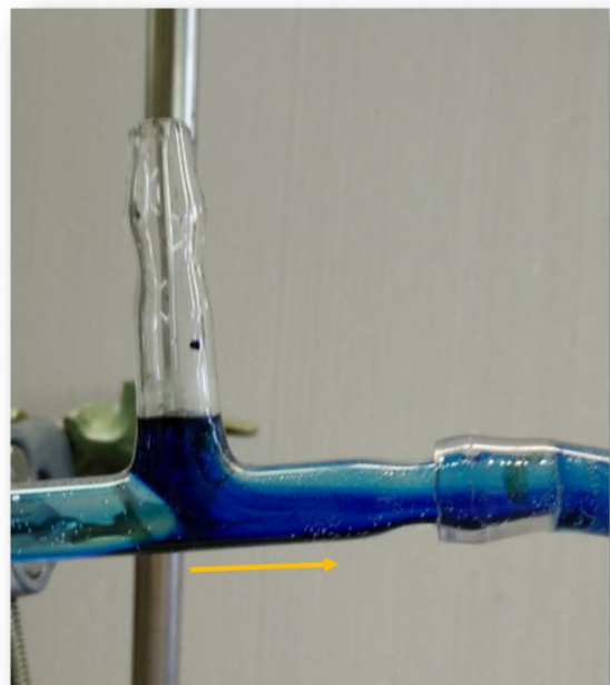
Abb. 2: Farbloses Wasser strömt von links an der Öffnung des T-Stücks vorbei und schiebt die blaue Methylenblaulösung durch das Schlauchsystem
