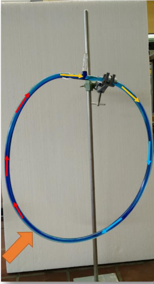
Abb. 1: Vom Punkt der Erwärmung aus (breiter orangener Pfeil) bildet sich eine Zirkulation im Uhrzeigersinn
