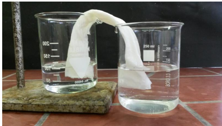
Abb. 1 - Aufbau des Versuchs. Das untere Glas füllt sich mit Wasser.
