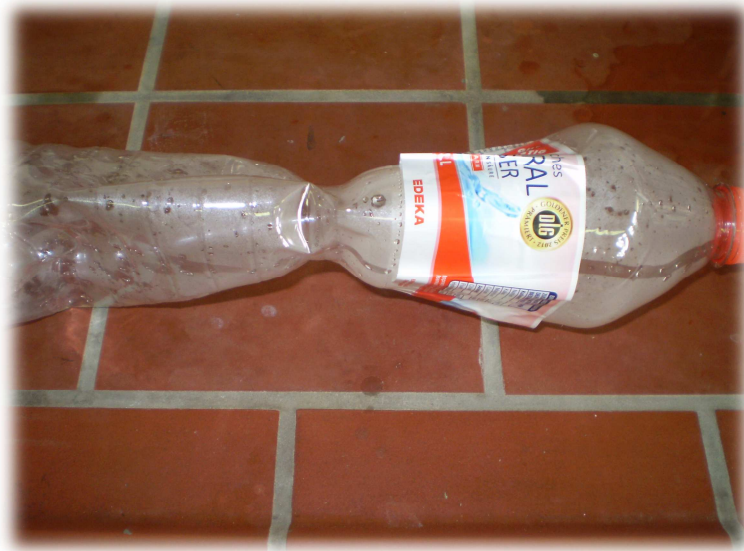
Abb. 3 - Durch Auswirkung des Luftdrucks eingedrückte Flasche
