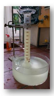
Abbildung 1: Versuchsapparatur nach Zugabe der zweiten Brausetablette.
