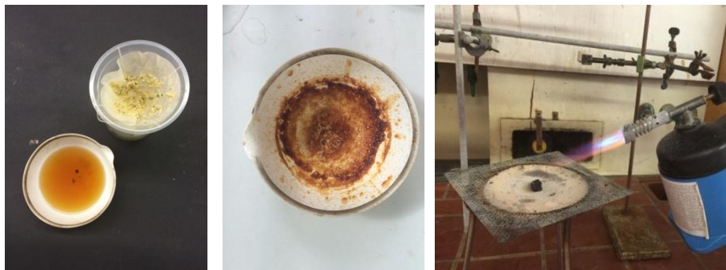
Abbildung 1: Nach der Filtration bleiben größere Teilchen im Filter zurück, das Filtrat ist braun (links); brauner Feststoff nach dem ersten Erhitzen (Mitte); brauner Feststoff wird von oben erhitzt (rechts).
