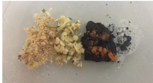
Abbildung 2 (von links nach rechts): Gemüsebrühe, Filterrückstände (Fett, Gemüse,...), brauner Feststoff während des 2. Erhitzens, extrahiertes Salz.
