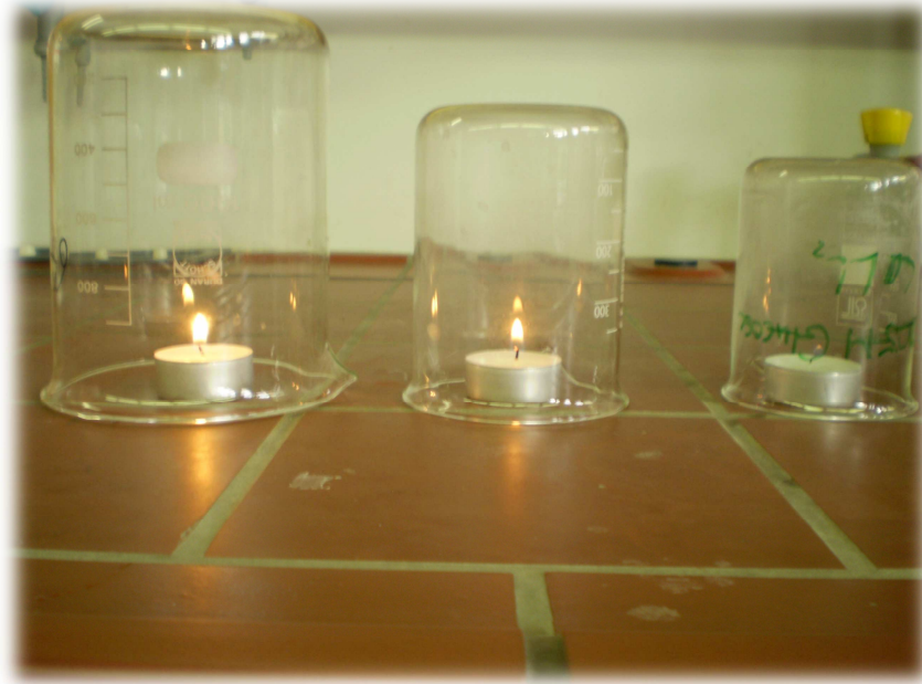
Abb. 5: Drei Teelichter unter unterschiedlich großen Bechergläsern
