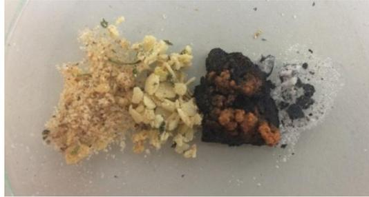
**Abbildung 2 (von links nach rechts): Gemüsebrühe, Filtrerrückstände (Fett, Gemüse,...), brauner Feststoff während des 2. Erhitzens, extrahiertes Salz.**
