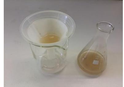
**Abbildung 4: Das Gemisch aus Sand, Salz und Wasser (links) nach dem Dekantieren (Mitte) und dem Filtrieren (rechts).**
