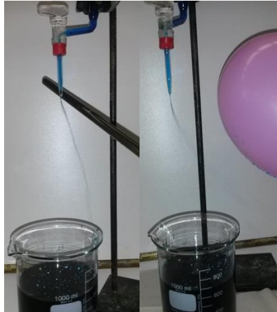
Abb. 1 - links Ablenkung durch einen Kunststoffstab und rechts Ablenkung durch einen Luftballon.
