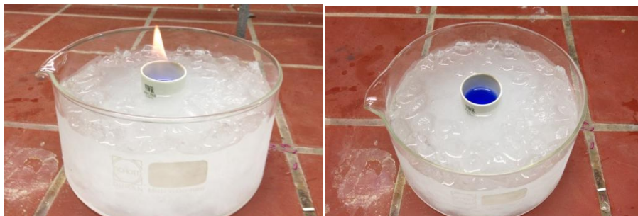
Abb. 1 - Löschen eines Petroleumbrandes mittels einer Eis-Viehsalz-Mischung.
