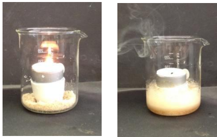
Abb. 2 – Erlischen eines Teelichts in CO 2 -Atmosphäre.
