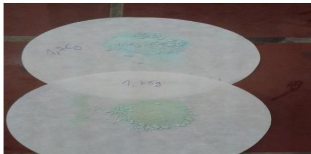
Abb. 4: Wasseraufnahme von Kupfersulfat
