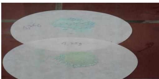
Abb. 4: Wasseraufnahme von Kupfersulfat
