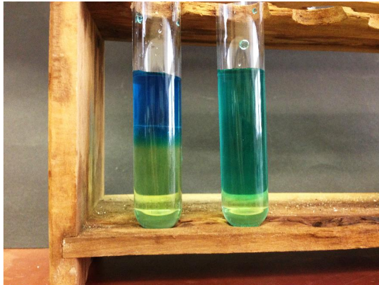
Abb. 1 - Phasengrenze des Leitungswasser in der Natriumchlorid-Lösung. (links) vs. Durchmischung der beiden angefärbten Leitungswässer (ohne Natriumchlorid), (rechts).
