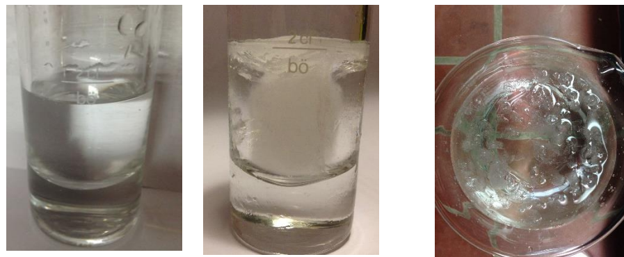
Abb. 1- Volumenzunahme nach Gefrieren (links vs. Mitte) und Schwimmverhalten von Eis auf flüssigem Wasser.
