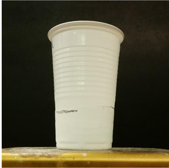
Abbildung 2: Becher mit gefrorenem Wasser. Der rechte, etwas höher gelegene Strich markiert die Füllhöhe des Eises nach dem Gefrieren, der rechte untere Strich markiert die Füllhöhe des flüssigen Wassers.
