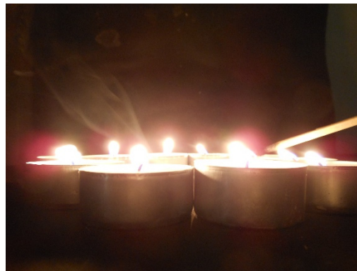
Abb. 2 - Rauchpartikel machen die Windbewegung im Kerzenkreis sichtbar.
