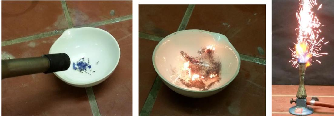
Abb. 1 – Eisenspäne (links), Brennende Eisenwolle (Mitte), Eisenpulver in Brennerflamme (rechts).
