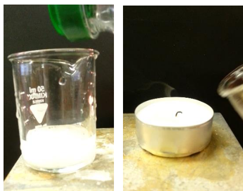
Abb. 3 - Beginn der Gasentwicklung, erkennbar durch Schaumbildung, nach Essigzugabe (links), erloschenes Teelicht nach „Auskippen“ des Gases (rechts).
