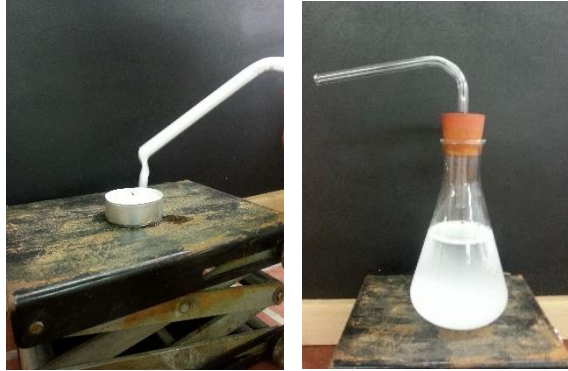
Abb. 2 – Löschvorgang der Kerzenflamme durch „Lösch“schaum (links), Aufbau des Feuerlöschers (rechts).
