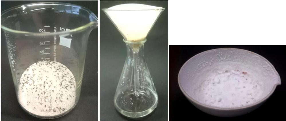
Abb. 1 - (von links nach rechts) Gemenge. Lösung nach dem Filtern. Zurückgebliebenes Salz nach dem Abdampfen des Wassers.
