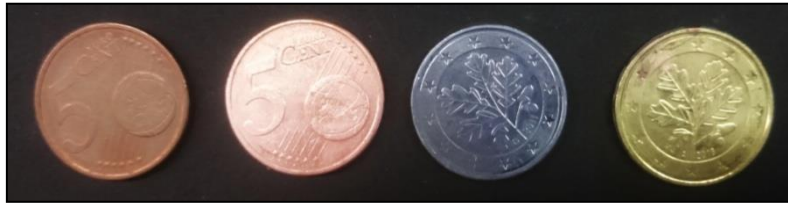
Abbildung 2 - (rechts nach links) unbehandelte Kupfermünze, gereinigte Kupfermünze, Kupfermünze nach Reaktion mit der Natriumhydroxidlösung und Zinkpulver, erhitzte Kupfermünze.
