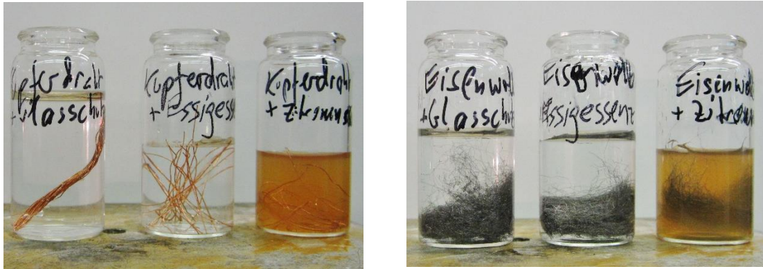
Abb. 1 - Versuchsaufbau mit Kupferdraht (links) und Eisenwolle (rechts). Nach zwei Tagen Farbveränderung in den linken Gefäßen leicht hellblau, in den rechten Gefäßen bräunlich.
