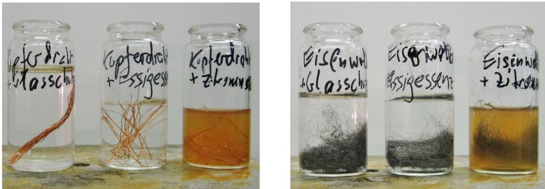
Abb. 3 - Versuchsaufbau mit Kupferdraht (links) und Eisenwolle (rechts). Nach zwei Tagen Farbveränderung in den linken Gefäßen leicht hellblau, in den rechten Gefäßen bräunlich.
