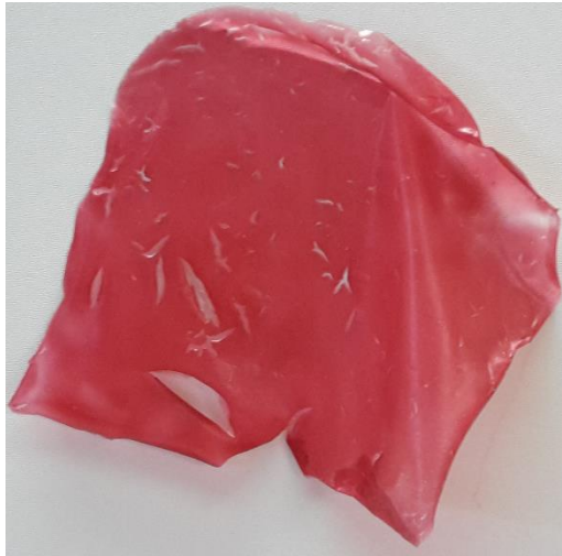
Abbildung 1: Rot eingefärbte Folie aus Maisstärke und Glycerin.
