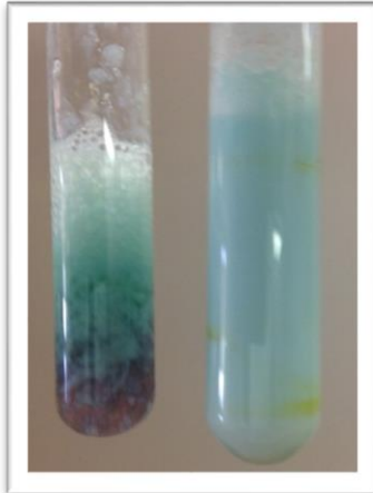
Abb. 2 - Biuret-Probe (links: Eiweiß, rechts: Milch (hier noch kein violetter Farbumschlag sichtbar)).
