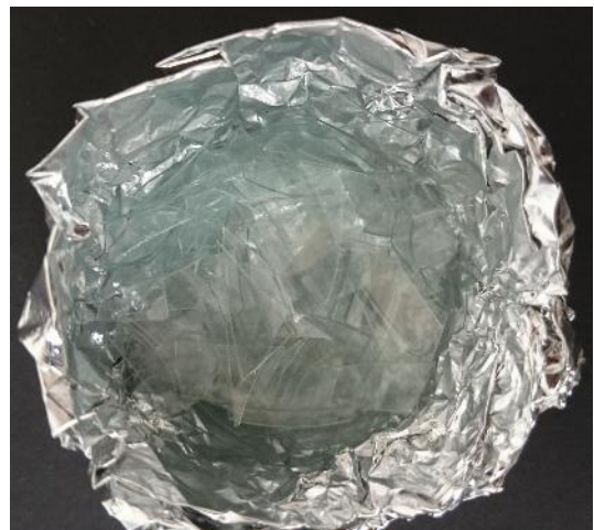
Abbildung 1: Zerkleinertes PET vor dem Versuch.
