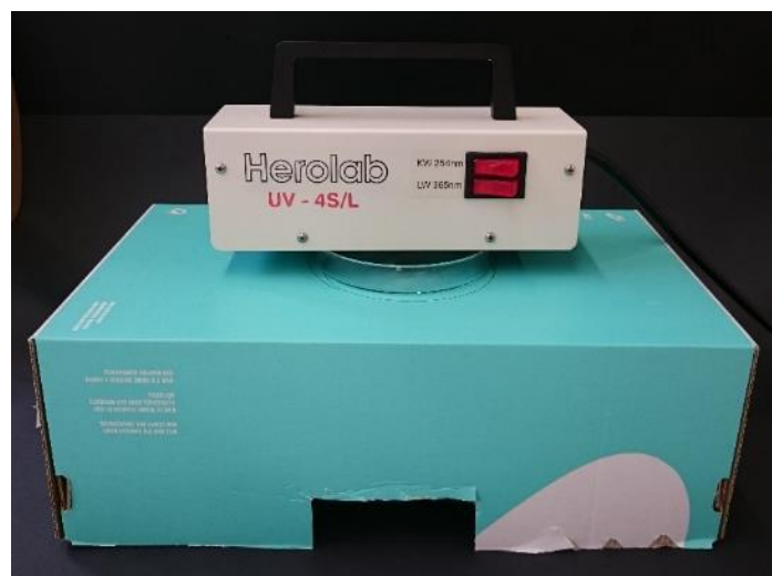
Abbildung 1 - Aufbau des Versuches, bestehend aus UV-Lampe, Petrischale und Schuhkarton mit Löchern.
