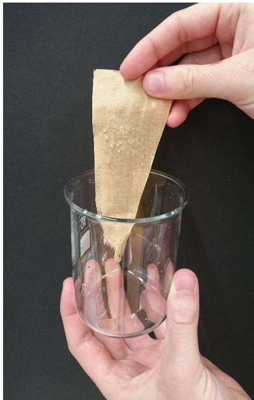
Abbildung 1 - Mit flüssigem Wachs beschichteter Streifen eines Kaffeefilters mit abperlenden Wassertropfen.
