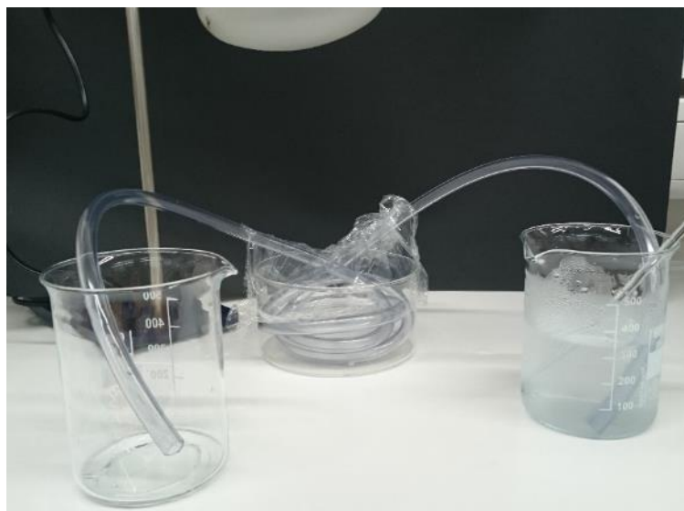
Abbildung 1 - Durchlauferhitzer mit Lampe und zwei Bechergläsern.
