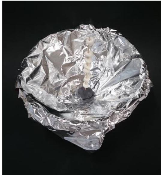
Abbildung 2 - Selbstgebauter Solarkocher.
