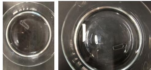
Abbildung 1: Büroklammer schwimmt auf dem Wasser (links). Büroklammer ist nach Zugabe von Spülmittel auf den Boden gesunken (rechts).
