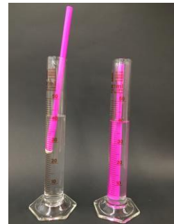
Abbildung 2: Schwebender Strohhalm mit Knete verschlossen (links) und Strohhalm ohne Knete (rechts).
