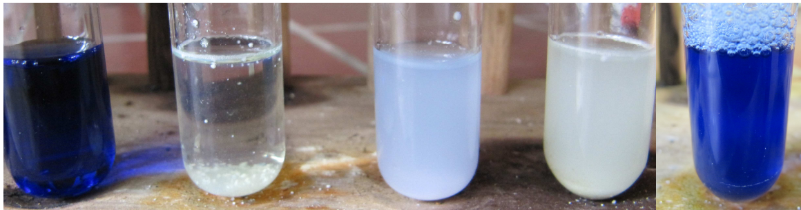
Abb. 4 – Versuchsergebnisse nach Schwenken der Reagenzgläser (1. Kontrolle, 2. Bleichmittel, 3. Color-Waschmittel, 4. Vollwaschmittel, 5. Flüssigseife).
