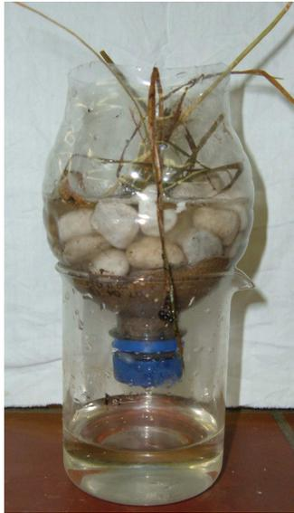
Abb. 5 -. Bodenfilter in Plastikflasche
