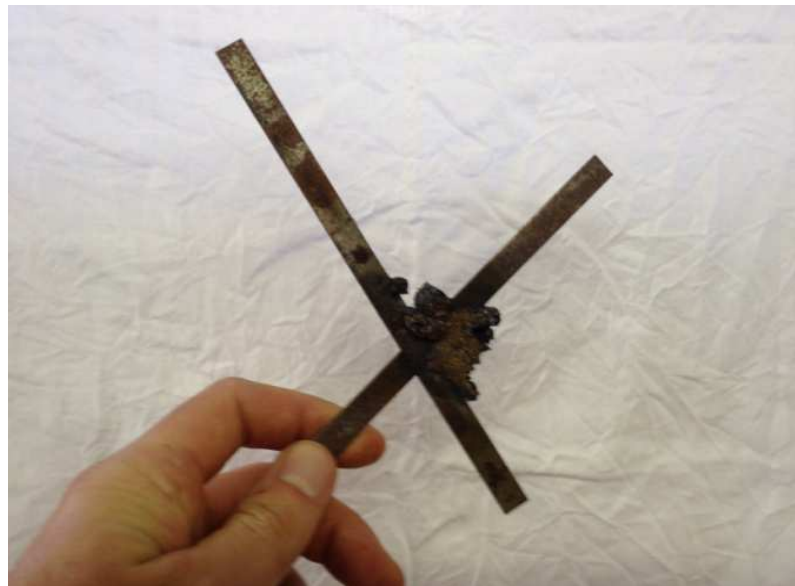
1: Abbildung 2: Zwei verbundene Eisenstangen als Ergebnis des Thermitversuches.
