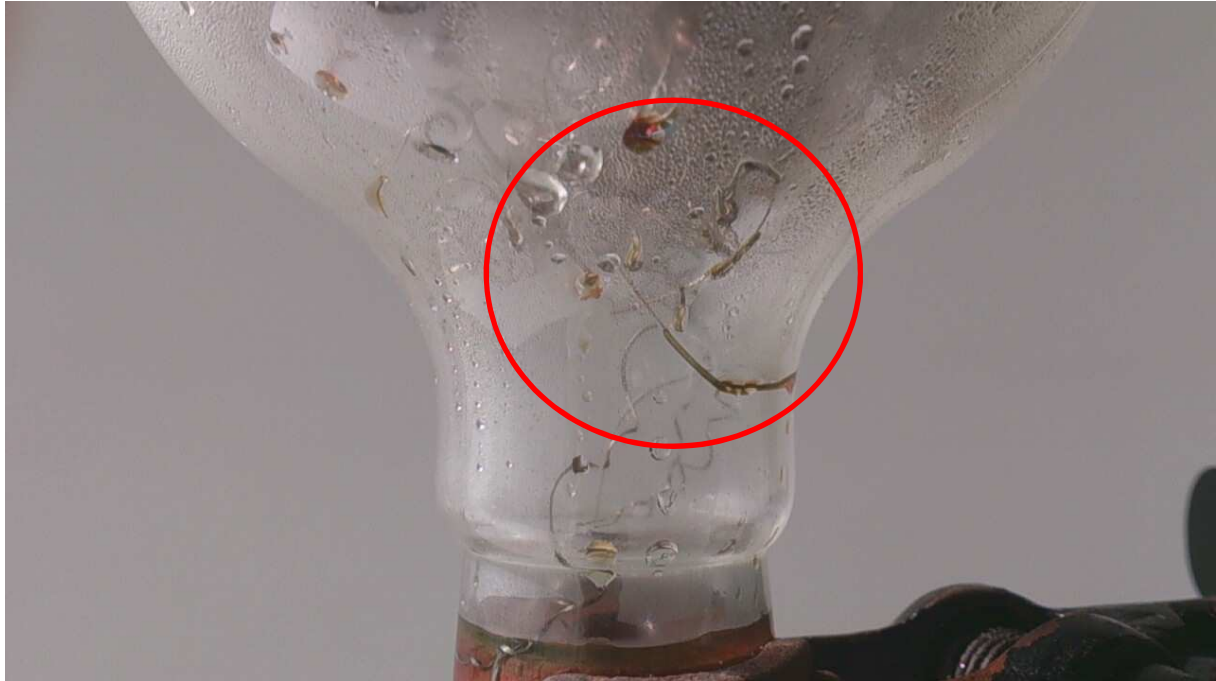
Abb. 7 – Beobachtung: Verfärbungen der Stahlwolle
