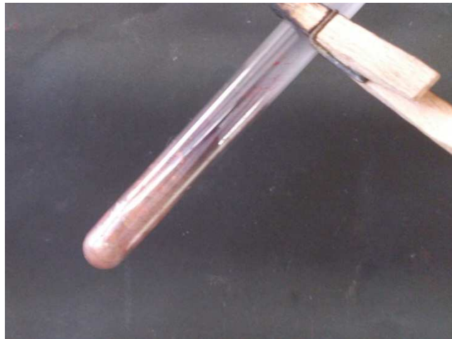
Abb. 12 – Nach dem Erhitzen: rot-goldenes, elementares Kupfer
