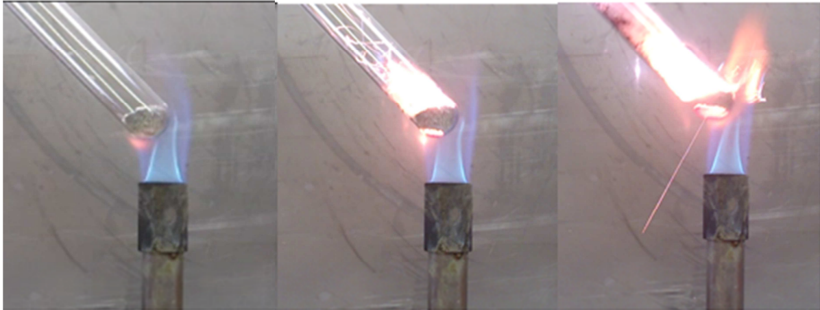
Abb.4 – Das Kupferoxid/Zink-Gemisch wird in der Brennerflamme erhitzt
