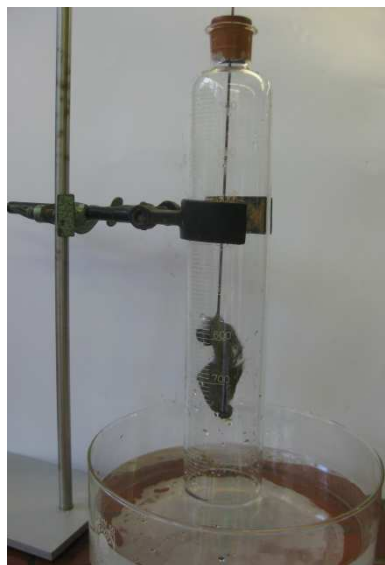
Abbildung 1 - Aufbau: Gasometer mit Eisenwolle
