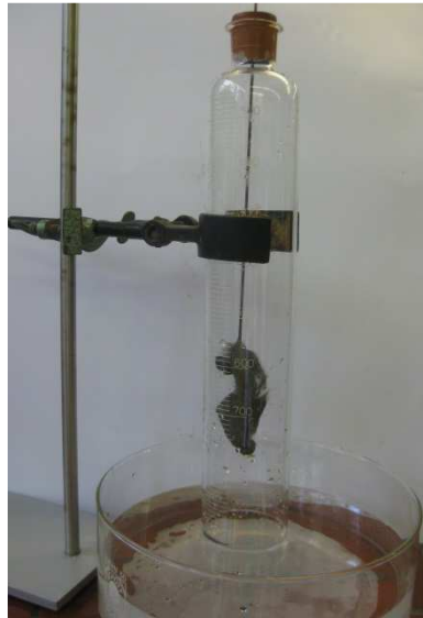
Abbildung 1 - Aufbau: Gasometer mit Eisenwolle
