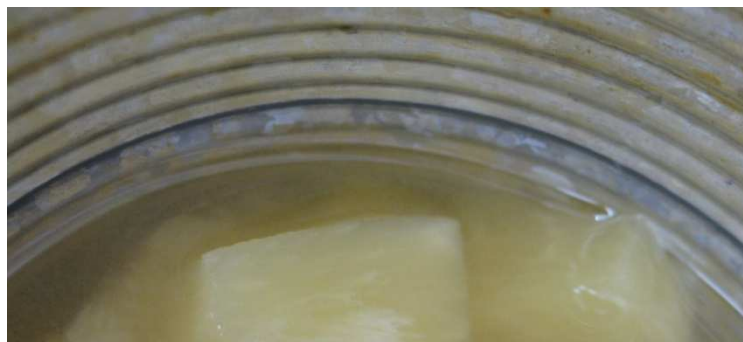
Abbildung 4 – geöffnete Ananaskonservendose nach 24 h
