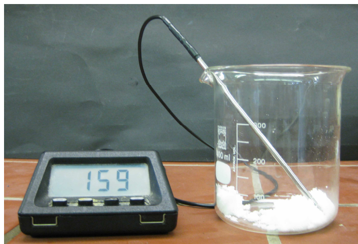
Abb. 6 - Versuchsaufbau zur Reaktion von Zinksulfat-heptahydrat mit Kaliumchlorid.
