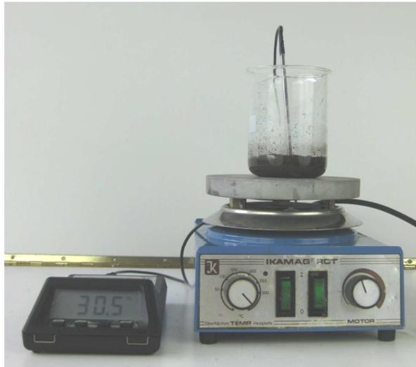
Abb. 4 - Versuchsaufbau der Reaktion von Kupferionen mit Eisen.
