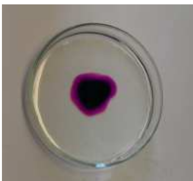
Abb.3a-c - Diffusion von Kaliumpermanganat in Wasser im chronologischen Verlauf (von a nach c)
