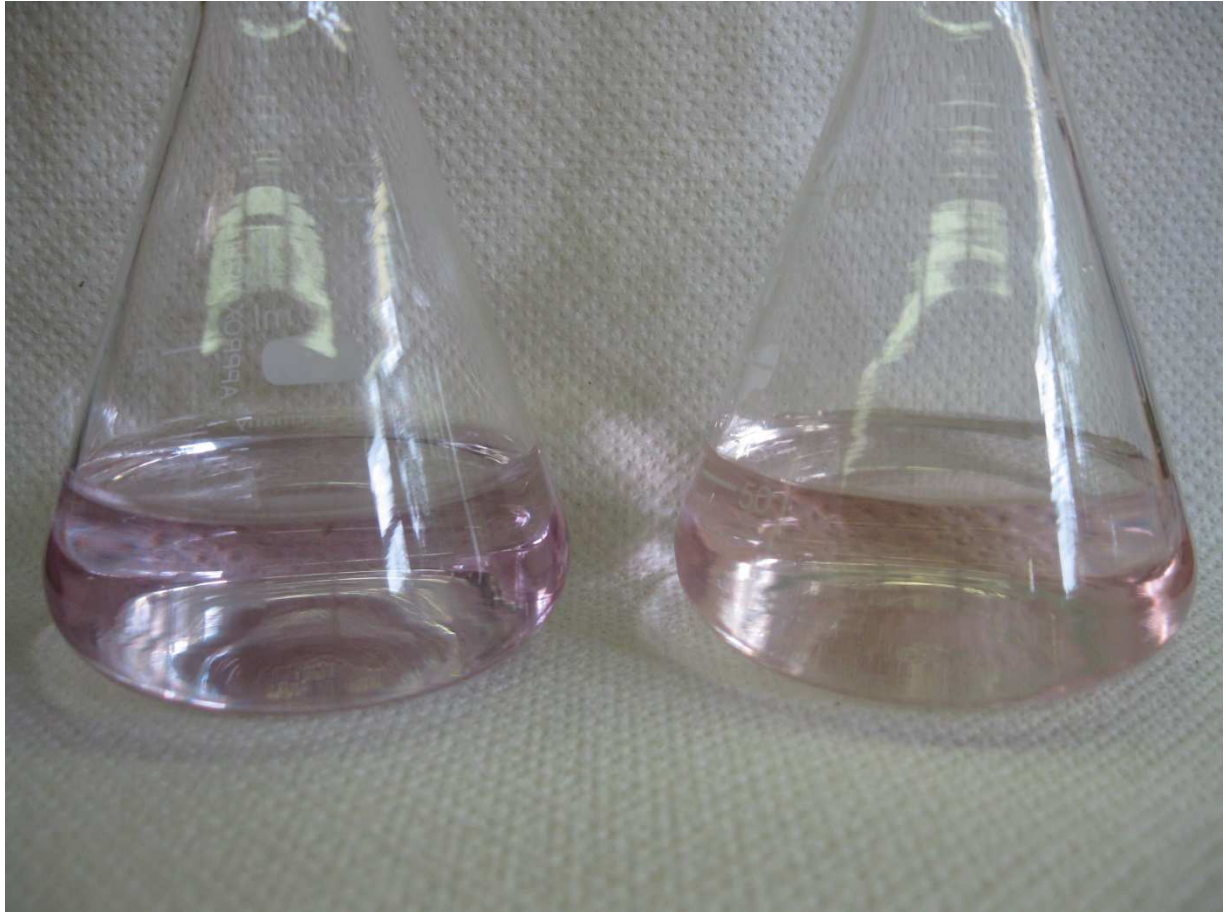
Abbildung 3: Lackmuslösung vor und nach Abgaseinleitung. Links: Lackmuslösung vor Zugabe von Autoabgasen, rechts: Lackmuslösung nach Zugabe von Autoabgasen
