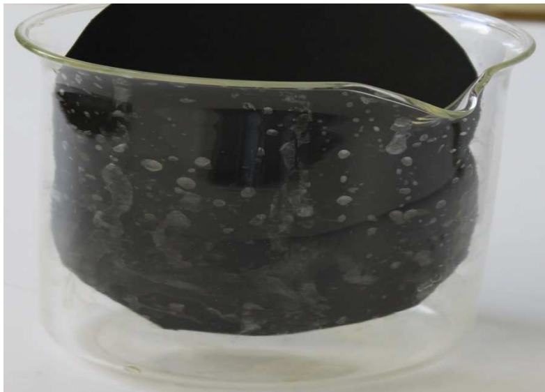
Abbildung 2: Durch Kohlendioxid getrübe Tropfen der Calciumhydroxid-Lösung im Becherglas
