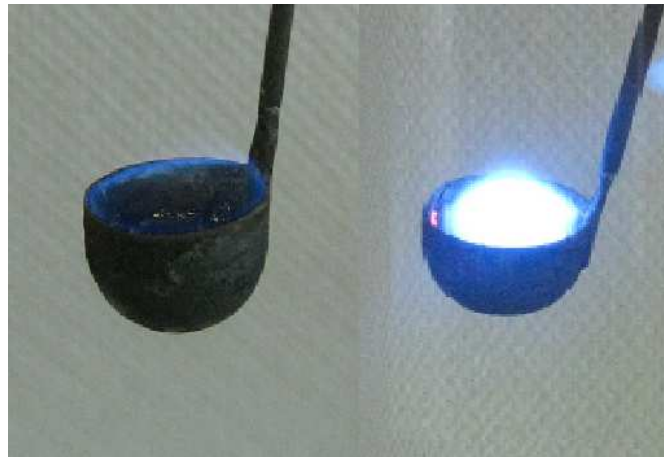
Abbildung 1: Verbrennung von Schwefel. Links: Verbrennung in der Luft, rechts: Verbrennung in Sauerstoff
