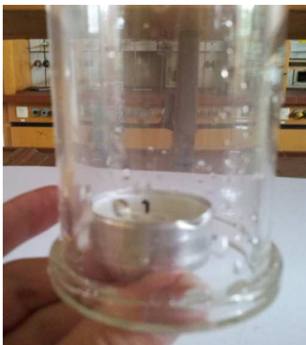
Abb. 1 – Kerze erlischt in dem umgedreht eingespannten Standzylinder
