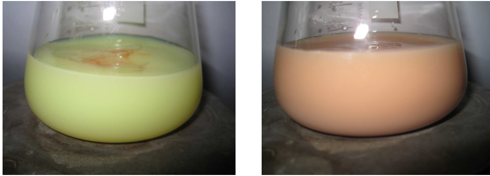
Abb. 3 – Fällungstiteration von Natriumchlorid mit Silbernitrat in Anwesenheit von Kaliumchromat. Links: zu Beginn der Zugabe. Rechts: Nach eindeutigem Farbumschlag.
