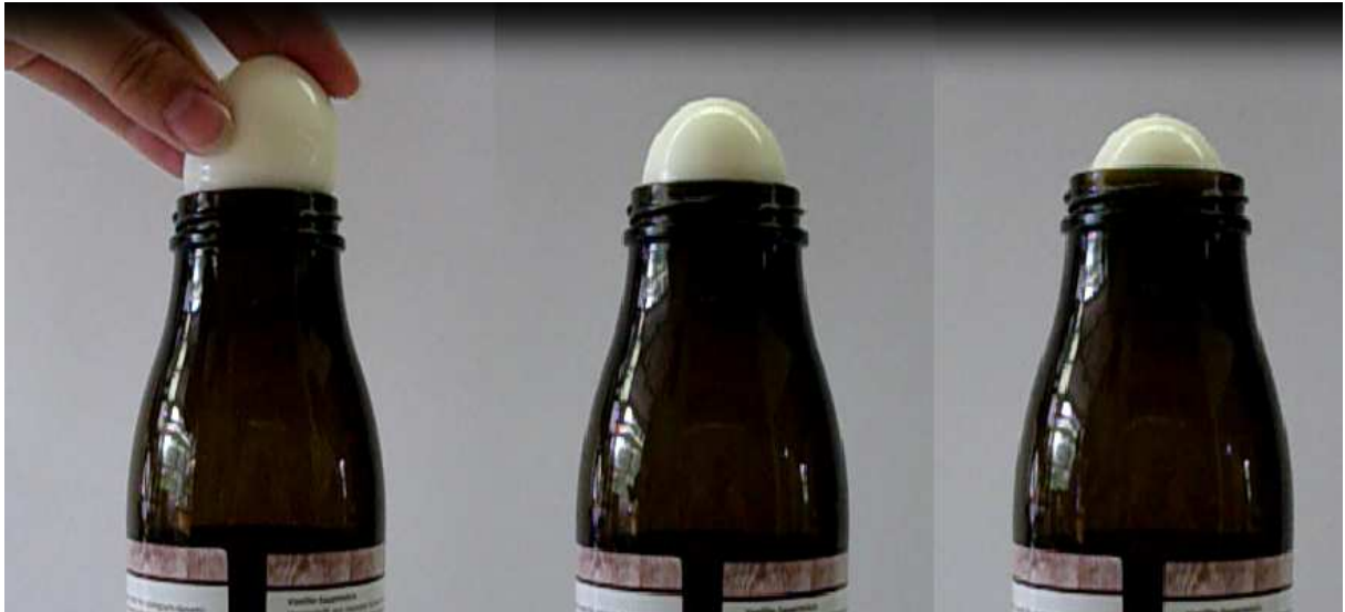
Abb. 4 - Das Ei wird aufgrund des zunehmend entstehenden Unterdrucks in die Flasche gesogen.
