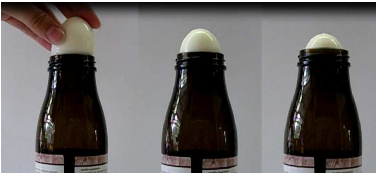
Abb. 4 - Das Ei wird aufgrund des zunehmend entstehenden Unterdrucks in die Flasche gesogen.
