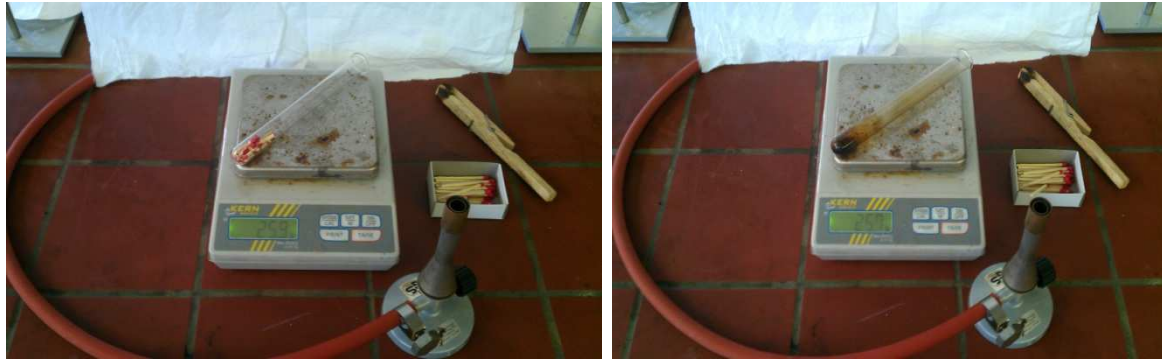
Abbildung 1 – Verbrennung von Streichholzköpfen in geschlossenem bzw. offenem System
