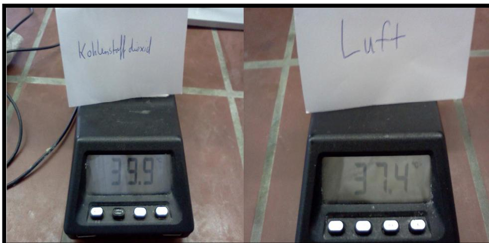
Abb. 7 - Temperaturunterschiede der Luft in beiden Bechergläsern
