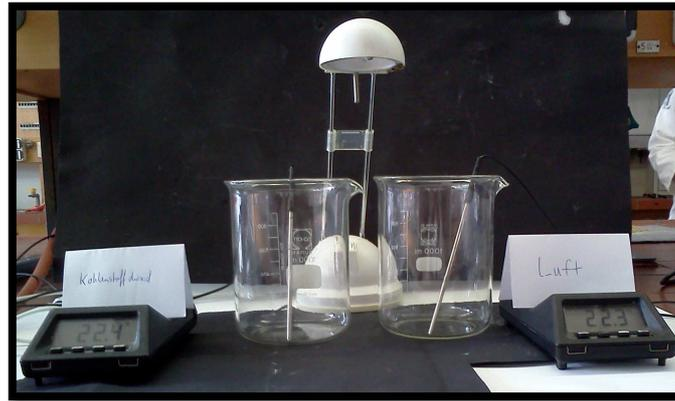
Abb. 6 – Versuchsaufbau „Treibhauseffekt“
