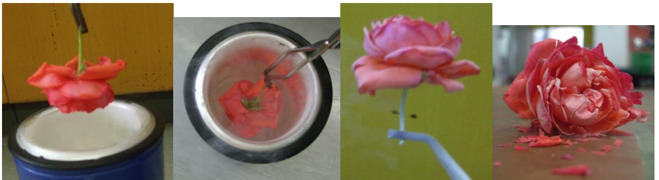
Abb. 3-6 - Durchführungs- und Beobachtungspunkt 2; Blume vor und nach Eintauchen in flüssigen Stickstoff
