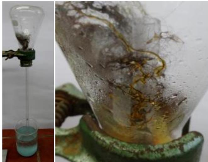
Abb. 6 – Versuchsaufbau (links) und die rostige Eisenwolle (rechts).
